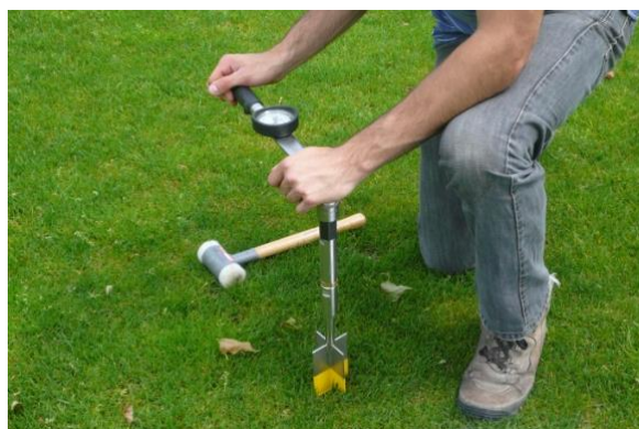
Mesurer la résistance au cisaillement à l'aide d'une clé dynamométrique
